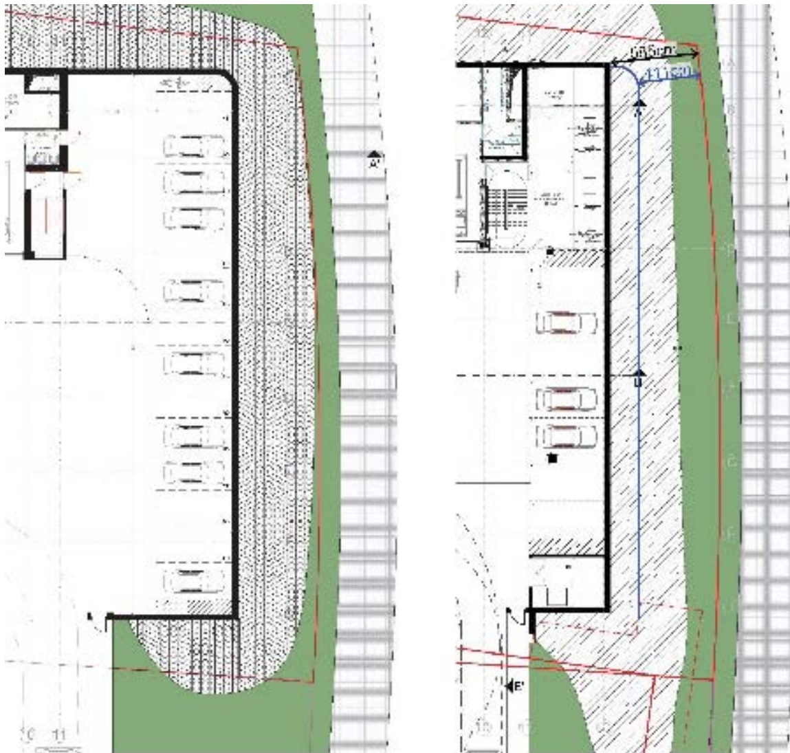
[Figuur 6: Vergelijking van de achteruitbouwstrook van het beknopte voorontwerp (links) en het huidige project (rechts)]
