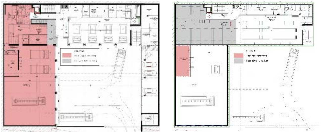
[Figuur 34: Ventilatiezones - Boveraanzicht]
