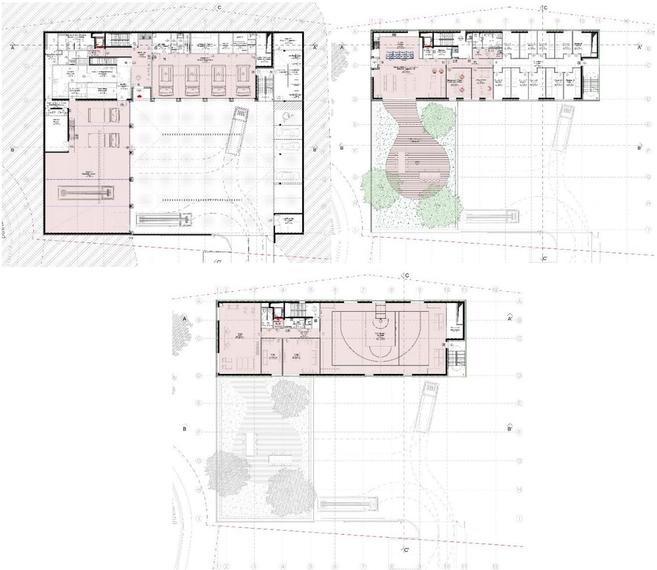
[Figure 9 : zones accessibles aux PMR. En haut à gauche : RDC. En haut à droite : R+2. En bas : R+3. Les vestiaires au R+1 et les chambres au R+2 sont destinées au personnel de garde, et ne sont donc pas prévus pour PMR ou visiteurs]
