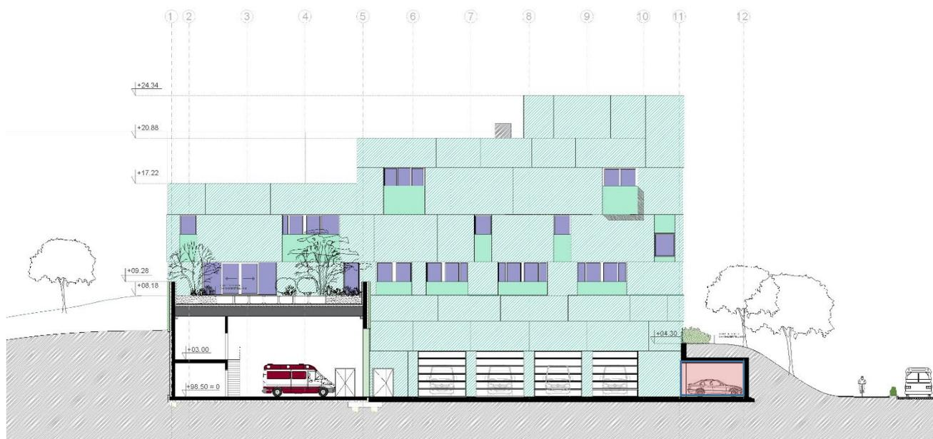
[Figure 5 : Coupe BB' montrant la bande fonctionnelle sous le talus (en rouge)]
