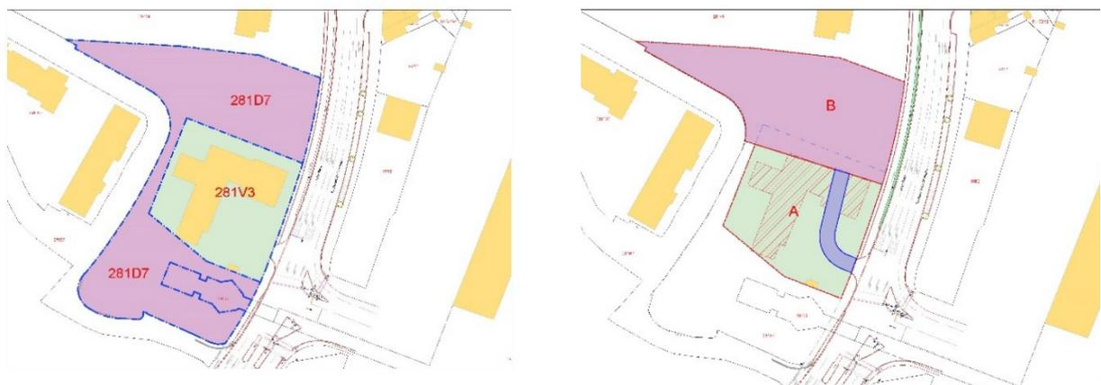
[Figure 1 : Plan parcellaire existant (à gauche) et projeté (à droite). En bleu – la servitude de passage]
